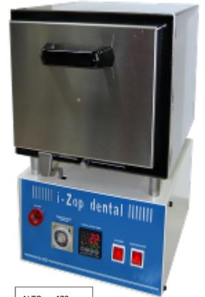
Horno de precalentamiento de cilindros de subida directa. Regulador de temperatura digital sencillo y preciso. Incorpora un programador de tiempo de espera o retardo para el inicio del proceso de calentamiento.
